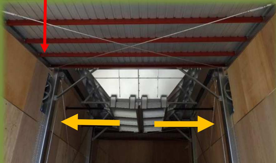
内部:トラック 引き取り時 黄色矢印へ扉を開閉し のこくずを排出します。
