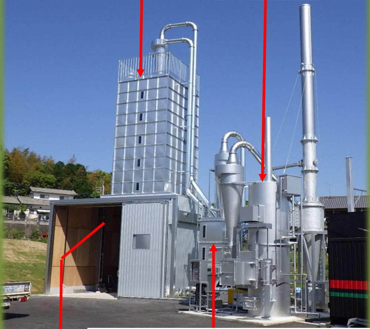
のこくずを焼却炉へ一定量ずつ送る定量送り機
